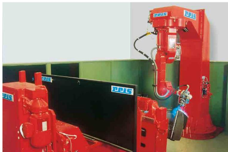
A fabricação da estrutura metálica dos chassis dos carros é realizada através de um robot de solda de 10 eixos. Desta forma, são garantidos tempos reduzidos e resultados de solda homogêneos.
