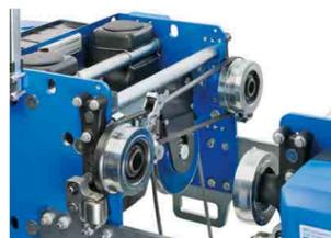
O diferencial modular de cabo de aço é acionado por um carro de direção com um conversor de frequência. O motor tem 4 polos controlado com variador de frequência. A velocidade de elevação pode ser ajustável infinitamente ou usada como comutação. A velocidade máxima de elevação depende da carga e atinge o dobro da velocidade nominal de elevação quando está vazia. Uma técnica indutiva de medição patenteada que garante a pesagem da carga mesmo com o diferencial parado.
