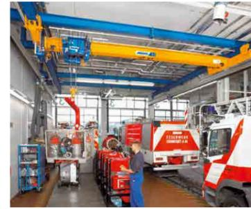
As **pontes Rolantes Suspensas ABUS** são instaladas em caminhos de rolamento colocados no tecto em vez de estarem apoiadas nas colunas do armazém. Têm uma maior aproximação lateral do diferencial que permite um aproveitamento máximo da largura do edifício.
