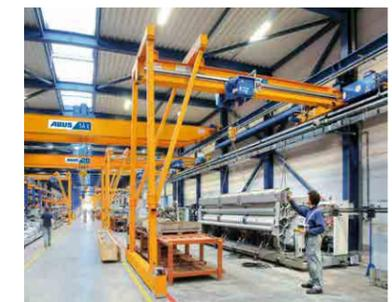
O **semi-pórtico monoviga ABUS** é construído com vãos de até 15 m e uma capacidade de até 10 t.
