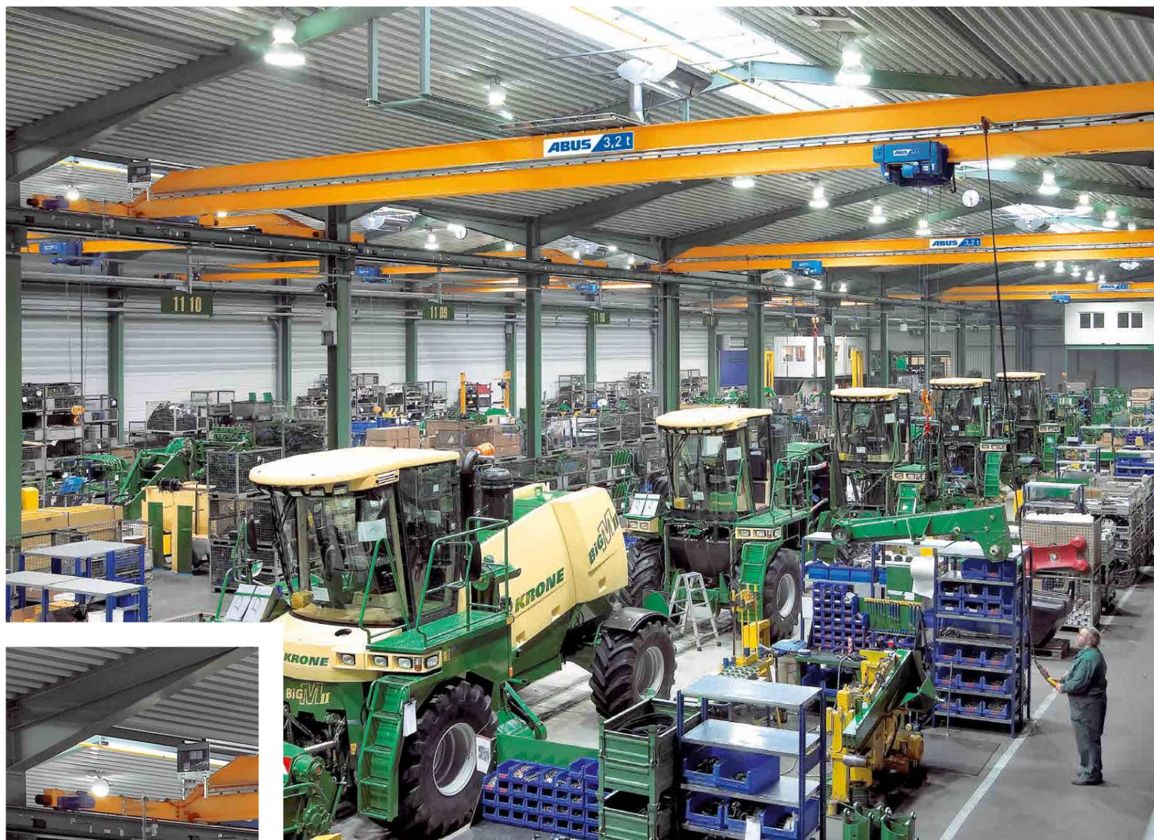
A solução ideal para novas construções: a ponte rolante monoviga ELK com viga principal de ângulo adaptado à forma do telhado (variante 3). Dessa forma, a altura construtiva disponível é utilizada de forma otimizada.
