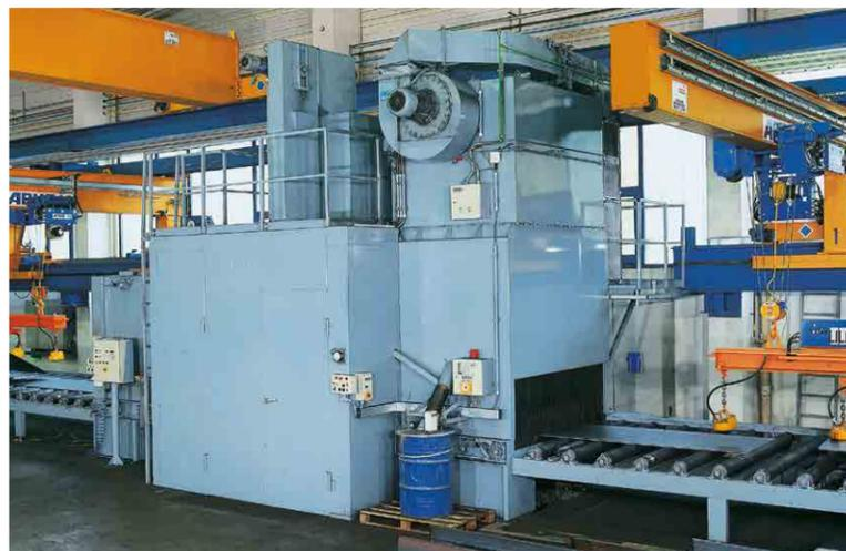
Após uma inspeção cuidadosa, as chapas de aço são limpas e decapadas para garantir uma excelente qualidade de soldadura e pintura. A cabine de jato de alta produtividade pode produzir superfícies de acordo com o DIN 55928, grau SA 2 1/2. Pode ser ajustado a qualquer grau de aço e espessura de placa.
