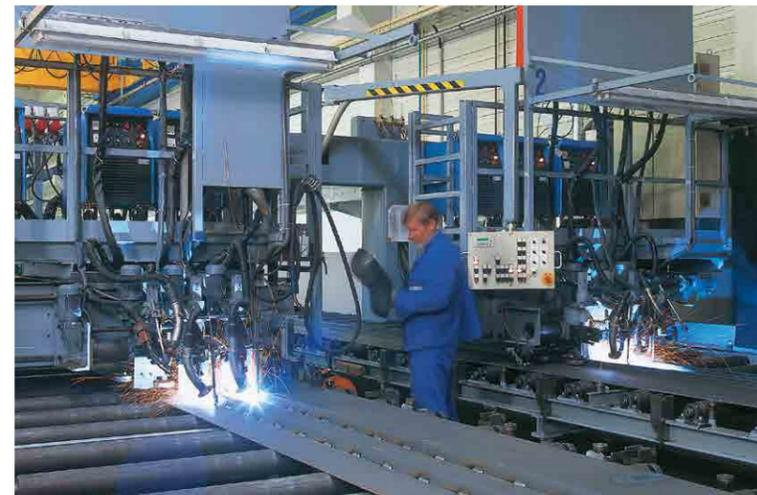
Antes da continuação dos trabalhos, as chapas laterais são reforçadas contra distorções com cantoneiras. Chapas de reforço dão à construção uma otimizada qualidade na estabilidade da estrutura. Após a montagem da barra do caminho do diferencial a viga caixão fica preparada para avançar para a soldadura.
