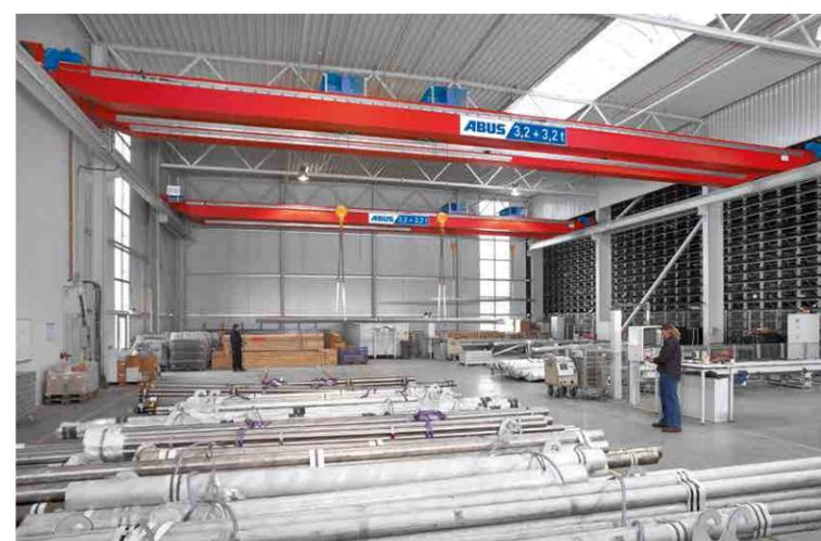
Os diferenciais cabo de aço ABUS com duas caídas atingem velocidades de elevação elevadas com capacidade de cargas até 20t.
