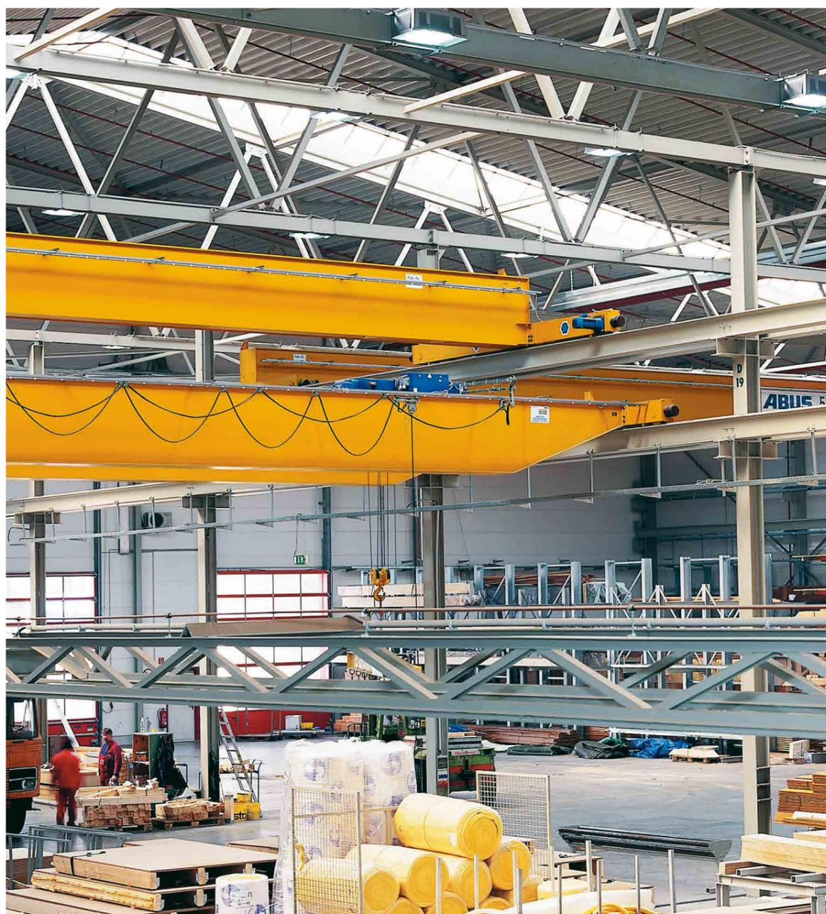
Se for necessário uma altura de elevação especial num espaço específico do armazém, as pontes rolantes ABUS podem ser instaladas em níveis diferentes. Nesta foto, é utilizada no primeiro nível uma ponte rolante
