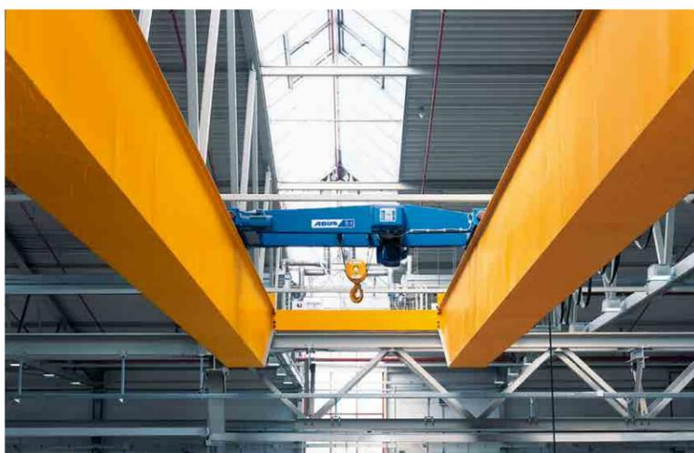
Carros de direção rebaixados possibilitam a utilização de pontes rolantes biviga em espaço livre reduzido acima do caminho de rolamento. Uma posição mais elevada da ponte conjugada com um carro de direção rebaixado pode ser uma vantagem decisiva, por exemplo, no transporte de grandes máquinas ou cargas de grande volume.
