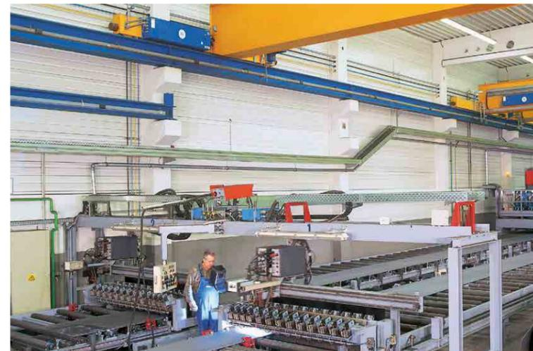
Placas do comprimento necessário para as vigas caixão são soldadas por uma máquina de solda controlada por PLC. A máquina de soldar pode processar placas de diferentes espessuras e o sistema de sequência automática garante a mais alta qualidade possível.
