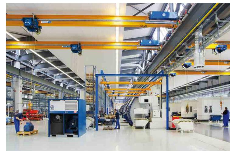
As pontes rolantes monoviga ABUS podem ser equipadas com níveis construtivos iguais ou diferentes para cada caminho de rolamento. Isto permite a divisão de um pavilhão em duas áreas, e com isso, um fluxo de trabalho especialmente flexível.
