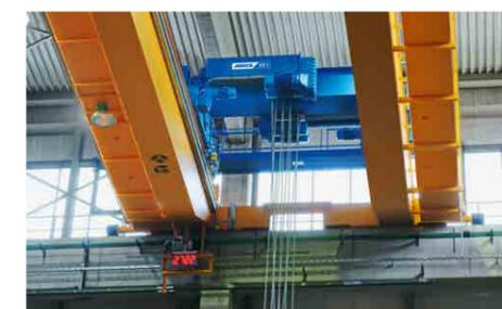
Os cabeceiros podem ser montados sobre oito rodas para uma melhor distribuição de carga. Assim, pode-se transportar cargas maiores com o mesmo caminho de rolamento, evitando o provável reforço na nave existente.
