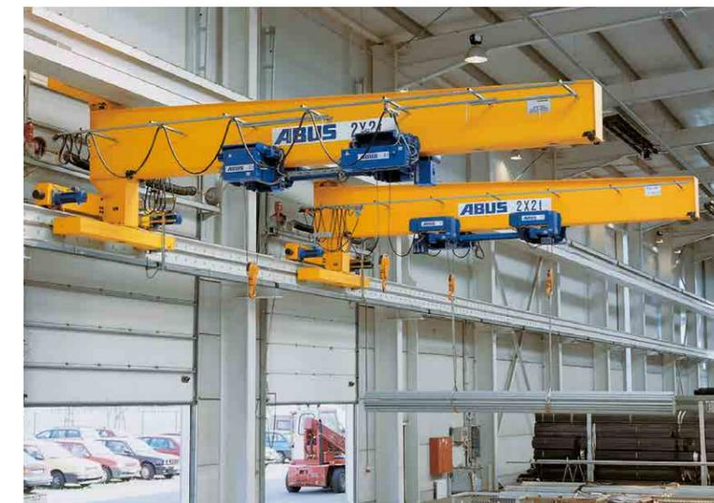
Com a utilização de dois diferenciais em tandem, a ponte rolante de consola ABUS pode também ser usada para um preciso posicionamento de cargas maiores.
