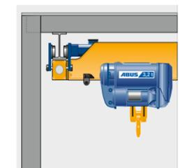
Conexão da viga principal Variante 2 Base do cabeceiro = base da viga (otimização da altura de elevação com a viga elevada).
