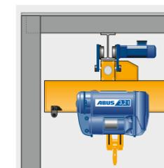
Conexão standard da viga principal - Variante 1 (saliência variável para pequena distância de aproximação do carro de direção).
