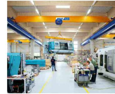
As **pontes rolantes monoviga** asseguram uma eficiente movimentação de carga mesmo em condições de espaço reduzido na área de produção ou armazéns. As pontes rolantes monoviga estão disponíveis em modelos de perfil laminado ou em viga caixão. Cada modelo pode ser construído com variantes construtivas de modo a economizar espaço e otimizar a posição mais alta do gancho.
