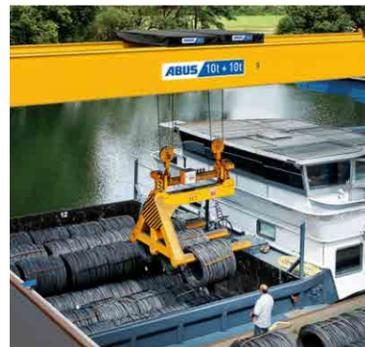
Os **dispositivos de elevação de carga** completam as pontes rolantes ABUS nas tarefas específicas de transporte. Assim, as pontes rolantes podem ser equipadas, por exemplo, para uso de sistemas por vácuo para elevação de chapas ou com ganchos tipo C para transporte de bobinas.
