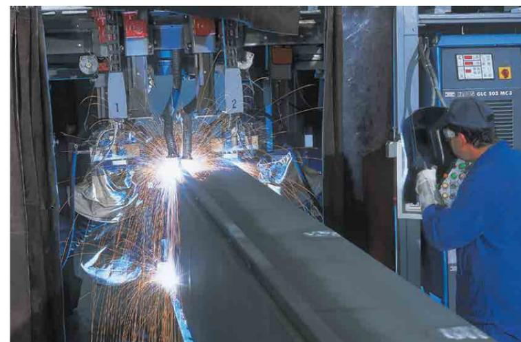
O robot de soldadura ABUS realiza até oito soldaduras ao mesmo tempo: chapas laterais, superior, inferior e caminhos de rolamento sobre a chapa superior. Os queimadores de alto rendimento são controlados automaticamente por CLP. Após a soldadura das chapas e da montagem dos cabeceiros, a ponte rolante recebe, para um perfeito acabamento, o sistema de pintura exigido caso a caso.
