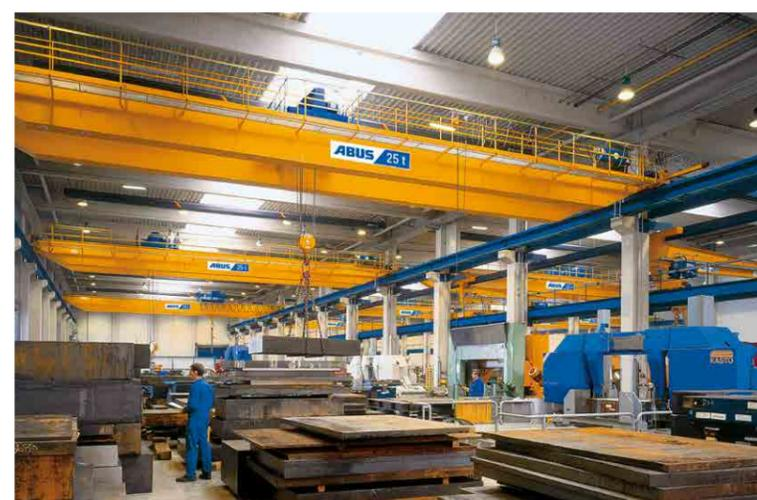
As pontes com plataformas de manutenção e varandim permitem chegar facilmente a todos os componentes da ponte, uma vantagem crucial na execução de serviços de manutenção.
