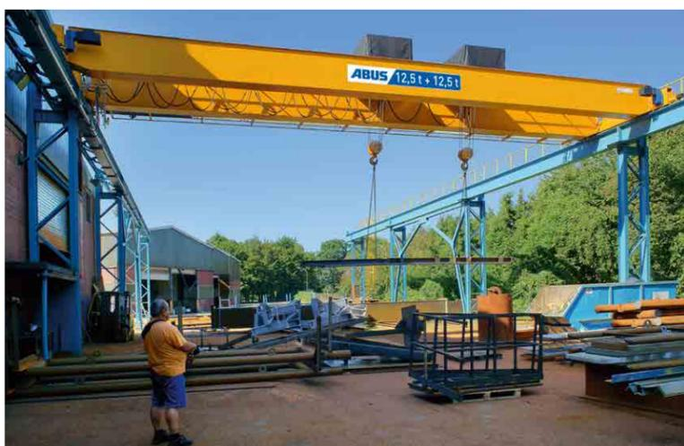
A sincronização electrónica do comando ABUS permite uma elevação simultânea com vários diferenciais, assegurando-se um posicionamento seguro e preciso da carga a qualquer altura, mesmo com espaçamento mínimo de gancho.
