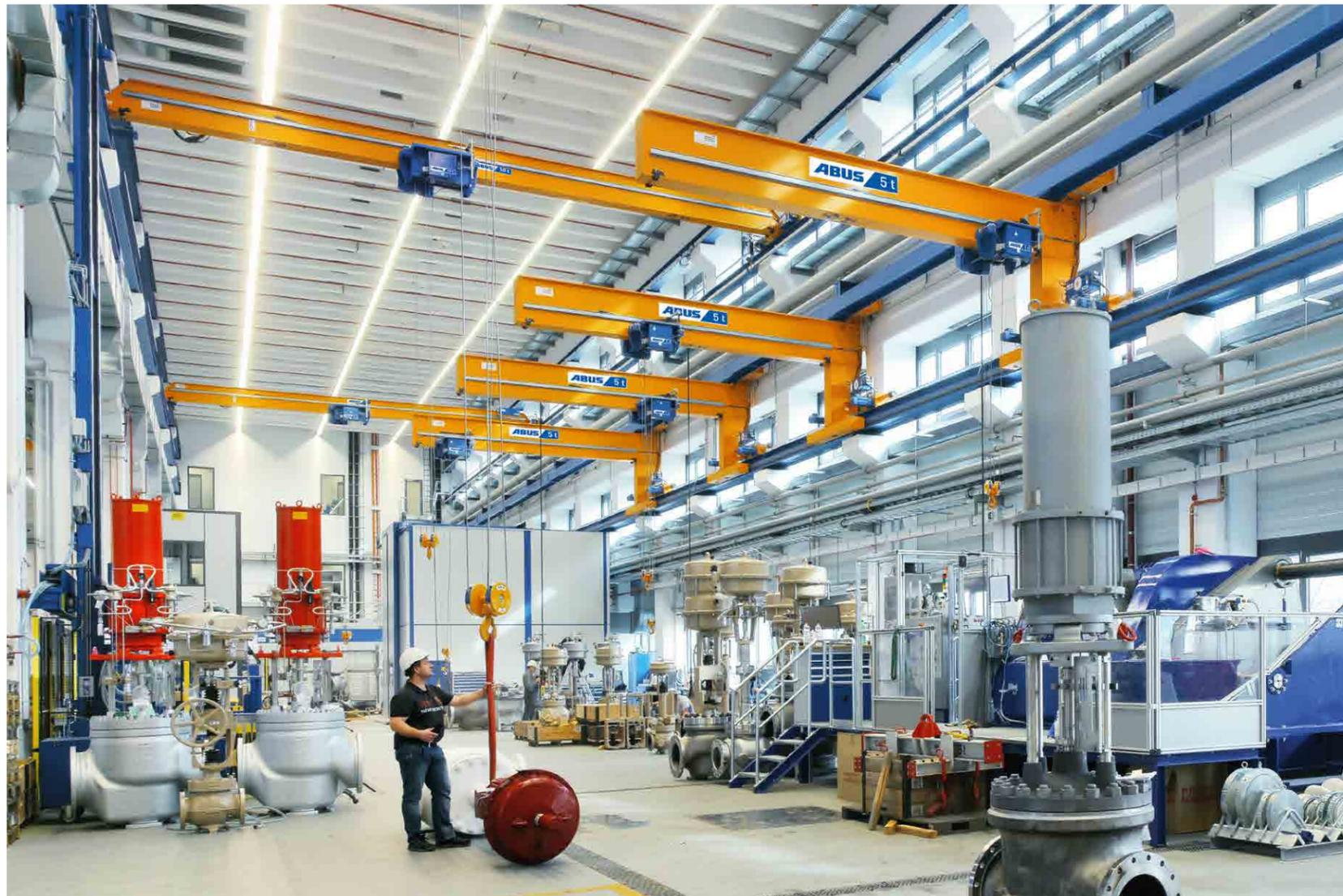
A ponte rolante monoviga de consola ABUS movimenta-se num nível inferior à das pontes rolantes maiores. Estas pontes proporcionam um fluxo de cargas sem atritos entre diferentes áreas de trabalho.
