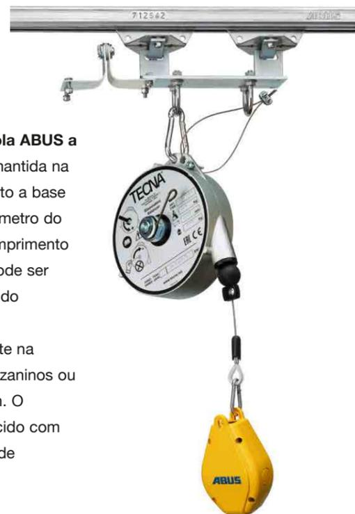
Com o **balancim de mola ABUS a botoneira** pendente é mantida na altura desejada. Enquanto a base da botoneira está a um metro do piso de operação, o comprimento do cabo de comando pode ser adaptado com o auxílio do balancim. Característica especialmente importante na operação a partir de mezaninos ou em poços de montagem. O balancim ABUS é fornecido com comprimentos de mola de 3 ou 4,5 m.
