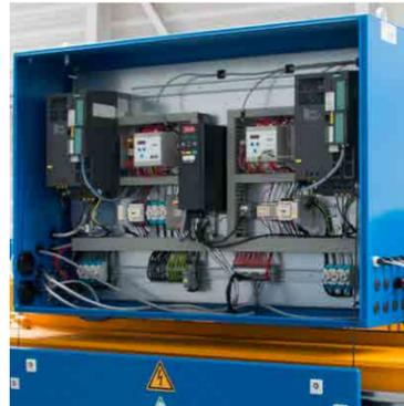
O sistema **ABULiner** permite uma solução confortável para quando os diferenciais têm velocidades variáveis para um exato posicionamento. Com este conversor de frequência a velocidade nominal máxima pode ser ultrapassada com carga reduzida. O sistema ABULiner é igualmente aplicável na translação da ponte e direção do diferencial.
