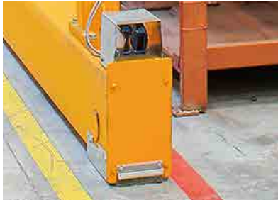
Dispositif anticollision sur sommier inférieur en série. Pas de rail au sol nécessaire ni de zone dédiée.
